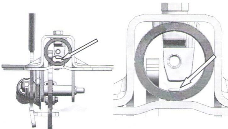
4) Sicherungsbolzen mit Innendurchmesser bündig. Ggf. Überstand der Sicherungsbolzen vorsichtig entfernen (z. B. mit Halbrundfeile)
